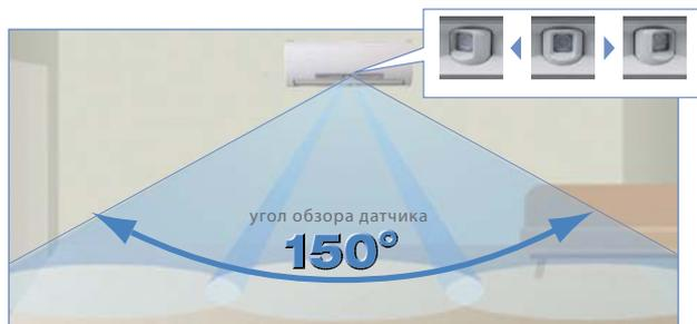
Обычно кондиционеры измеряют температуру воздуха на входе во внутренний блок, который часто располагают достаточно высоко. В результате температура в нижней зоне помещения не всегда оказывается комфортной. Датчик I SEE дистанционно измеряет температуру в нижней зоне, что особенно удобно, например, в детской комнате.
