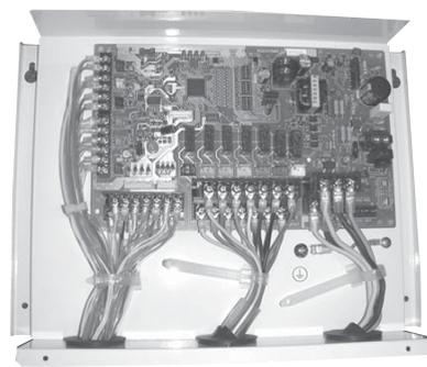
Контроллер РАС-IF031В-Е предназначен для управления тепловыми насосами „воздух–вода“ полупромышленной серии Mr. Slim, а также исполнительными устройствами контура теплоносителя: циркуляционным насосом, 3-х ходовым клапаном, проточным и погружным электронагревателями.
