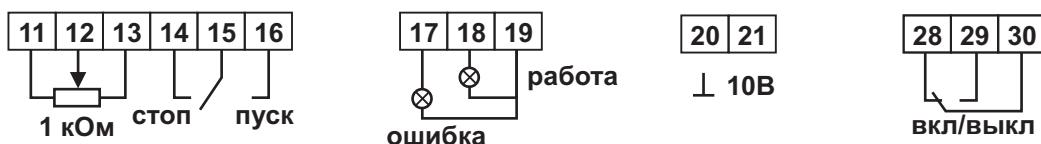
11, 12 и 13 — переменный резистор 1 кОм, внешнее управление скоростью вращения вентилятора, задание частоты подаваемого напряжения 25—50 Гц.
