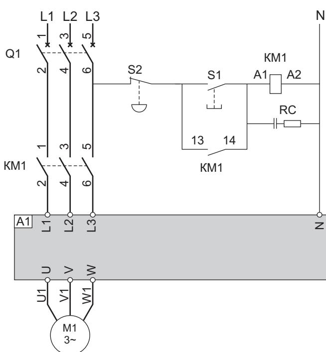
A1 - частотный регулятор РМТ;
