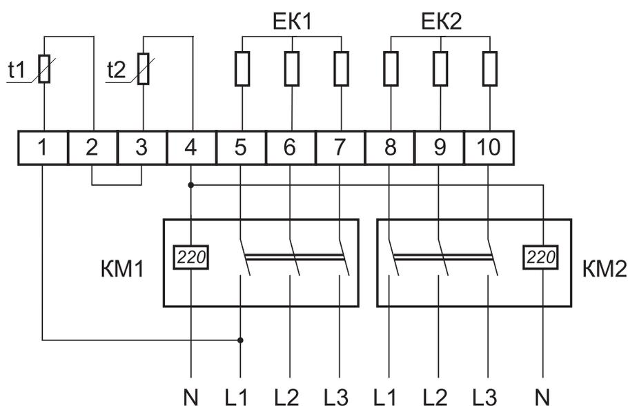
При срабатывании любого из биметаллических термовыключателей магнитный пускатель выключится и нагреватель прекратит работу. Для прямоугольных нагревателей необходимо установить перемычку 2—3. KM1 и KM2 — магнитные пускатели с катушкой на 220В.
