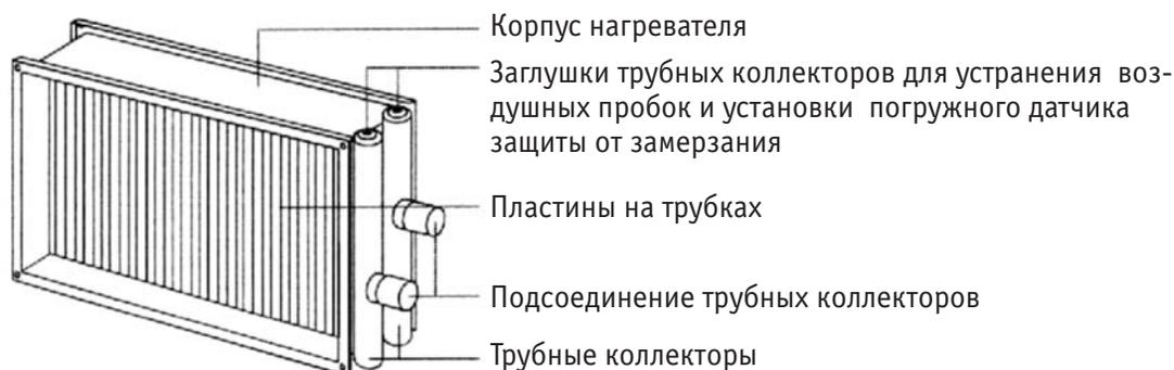
Двух-, трех- и четырехрядное исполнение с чередующейся геометрией, использованные материалы обеспечивают длительный срок службы и надежность работы.
