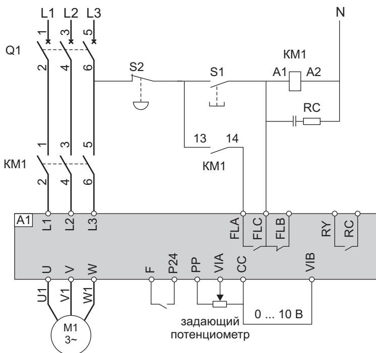
A1 - частотный регулятор ATV21;
