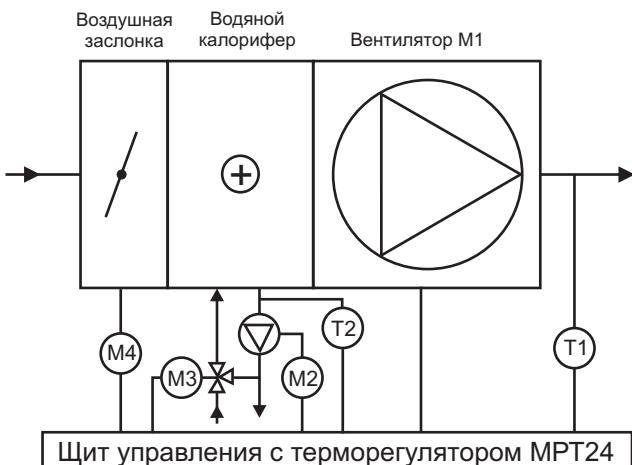
T1 - канальный датчик температуры (датчик TD1, производство завода «Лиссант»);
