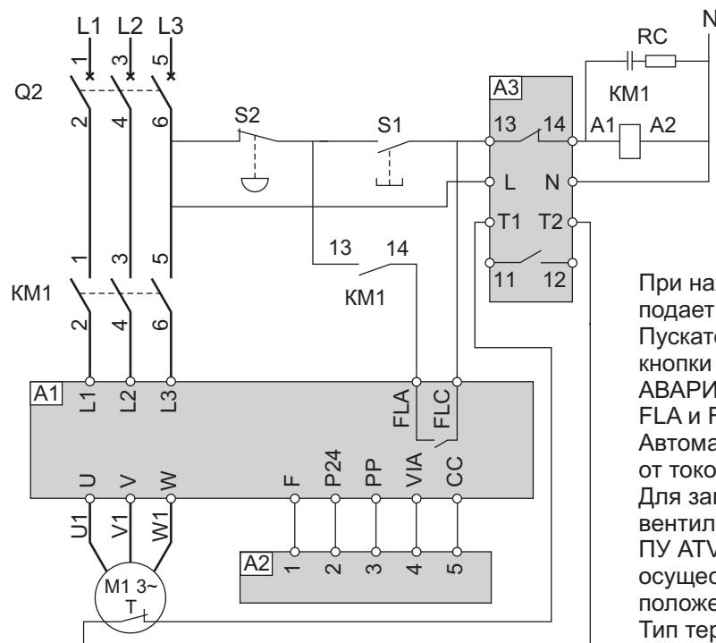
A1 - частотный регулятор ATV21;
