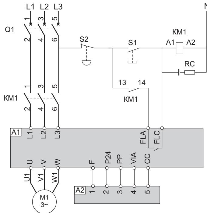
A1 - частотный регулятор ATV21;
