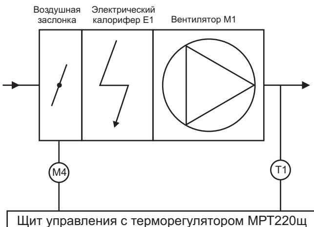
T1 — канальный датчик температуры (датчик ТД1 производство завода «Лиссант»);
