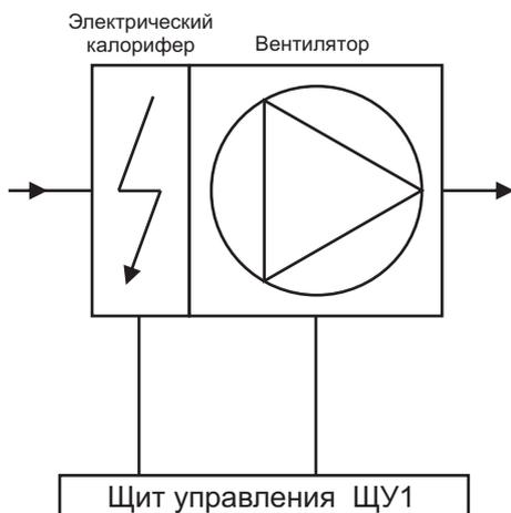
При нажатии кнопки ПУСК ВЕНТИЛЯТОРА происходит запуск вентилятора М1, и на передней панели щита управления загорится индикаторная лампа РАБОТА ВЕНТИЛЯТОРА.
