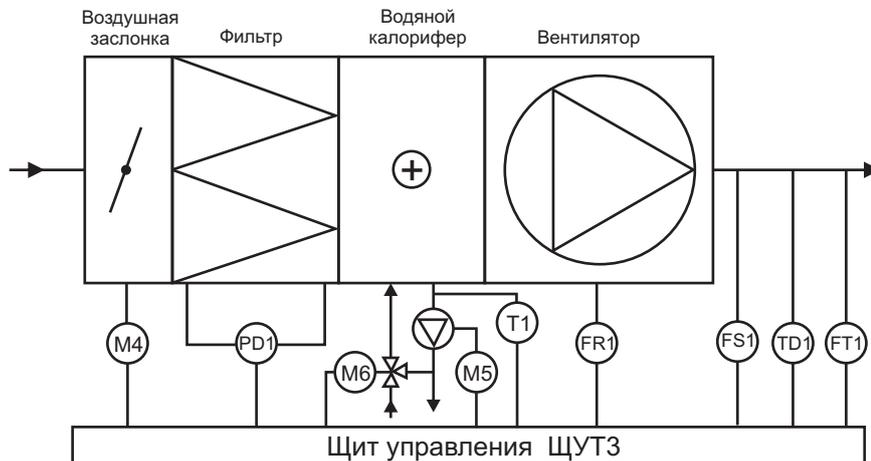
Щит управления ЩУТЗ осуществляет регулирование температуры приточного воздуха и защиту теплоносителя водяного калорифера NW1 от замерзания.
