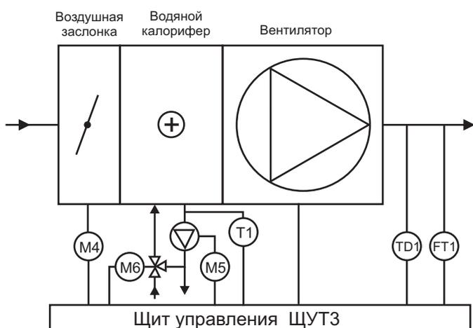
Щит управления осуществляет регулирование температуры приточного воздуха и защита теплоносителя водяного калорифера NW1 от замерзания.
