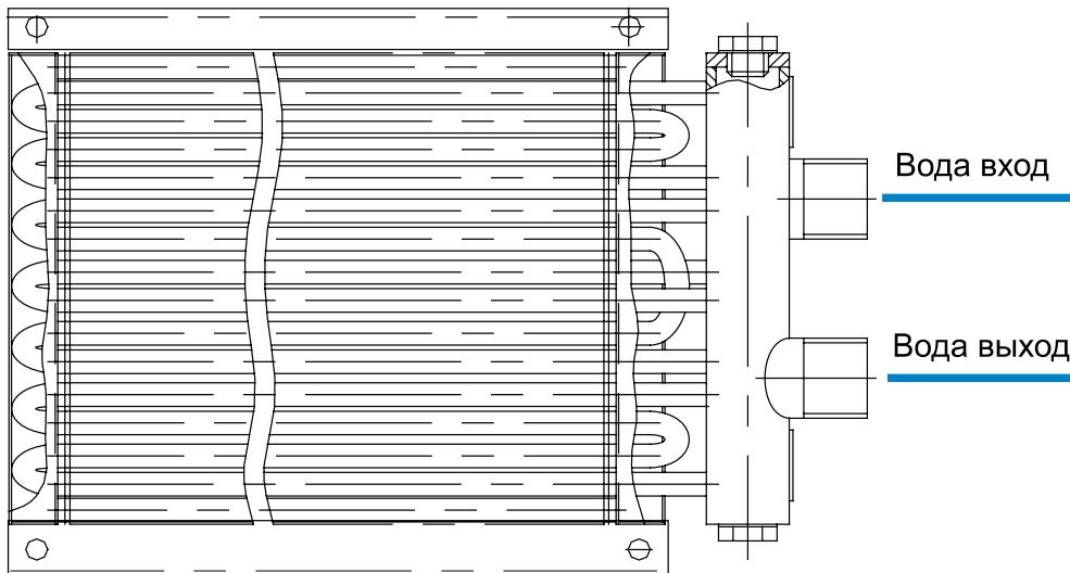
**Прямоточное подключение** - обеспечивает большую устойчивость к замерзанию, но дает пониженную мощность.
