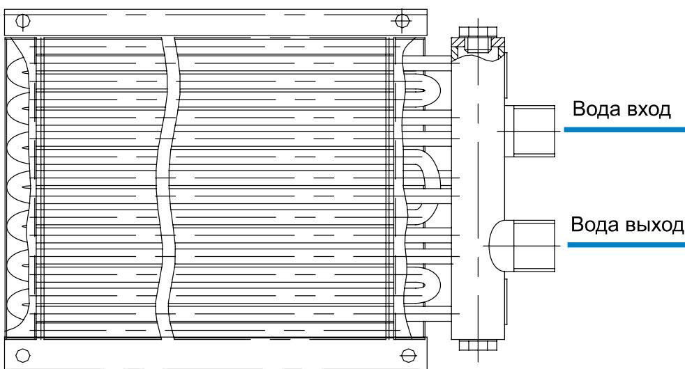
Водяные воздухонагреватели и смесительные узлы могут храниться только в сухих и чистых помещениях. В начале и конце отопительного сезона необходимо проверять воздухонагреватель и смесительный узел, а именно: падение давления воздуха или
